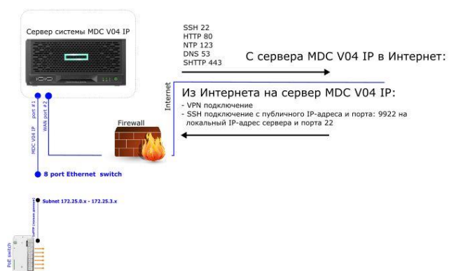
Рисунок № 11. Схема подключения сервера MDC V04 IP к Интернету
